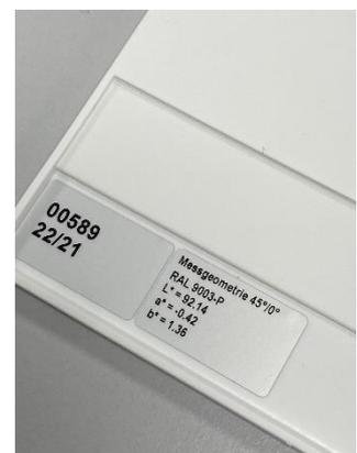
verwenden wir die RAL 9003-P und platzieren diese mit der Rückseite nach oben auf der umgestülpten Rezyklataufnahmeschale bzw. Inline im dafür vorgesehenen Schlitten und Quittieren nach getaner Arbeit mit **OK**. Bitte beachten: Der Abstand zwischen Sensorfrontend und RAL 9003-P sollte 75mm betragen.
