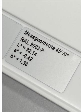
Eingabe des  $L^*a^*b^*$ -Farbwertes, ermittelt aus der  $45^\circ/0^\circ$ -Methode und dem entsprechenden Label auf der Karte zu entnehmen. Quittieren mit **OK**.
