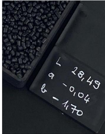
Der L\*a\*b\*-Farbwert des Spritzgussplättchens, das aus der gleichen Charge stammt wie das Rezyklat, auf das kalibriert werden soll, wird nun in die L\*a\*b\* PANEL-Oberfläche eingetragen. Anschließend wird durch Anklicken des **OK** Buttons die Eingabe quittiert.
